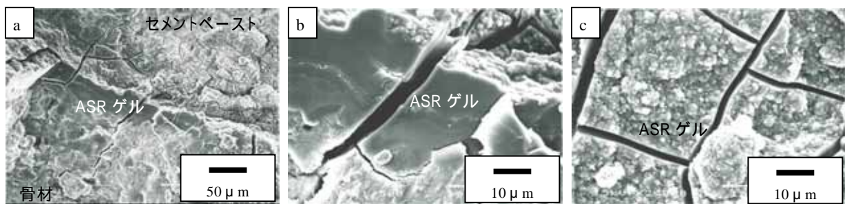
図-3 リチウムイオンを添加していない ASR ゲル試料の SEM 写真
