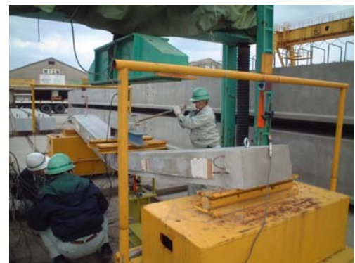
写真-3 はり載荷試験状況
