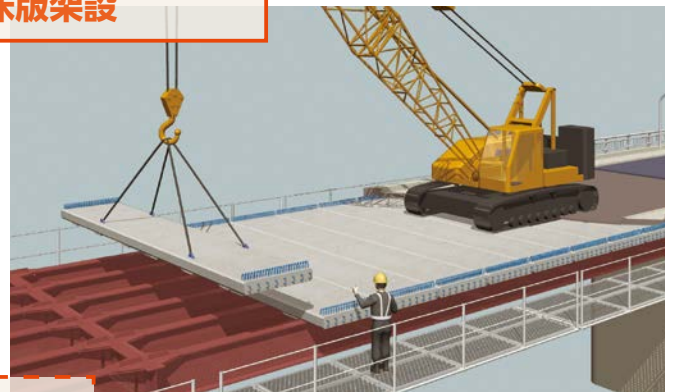
床版パネルの架設
