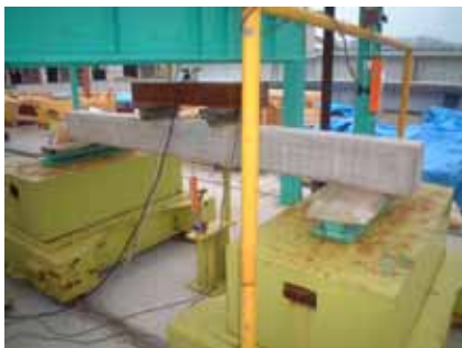
RC梁 曲げ載荷実験
