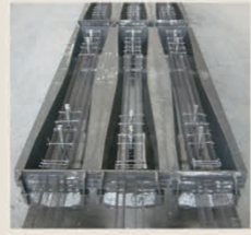
プレテンション 型枠
