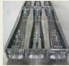
プレテンション 型枠
